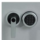
Serrure électronique classe 2 VDS, 1 000 000 de combinaisons alphanumériques, intatible, temporisée après la 3<sup>e</sup> erreur. 1 code maître et un code utilisateur programmable. Condamnation automatique à la fermeture de l'armoire. Alimentation par pile avec système extérieur de secours.
