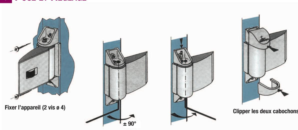
Fixer l'appareil (2 vis  $\varnothing$  4)
