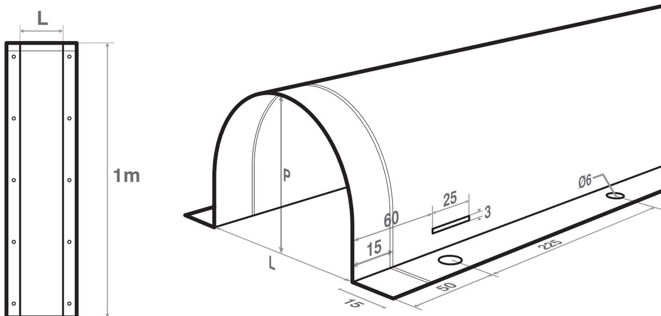
Épaisseur tôle d'aluminium : 12/10<sup>e</sup> = 1,2 mm
