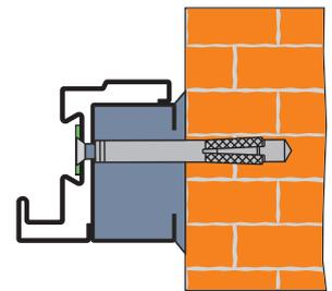
LVM: Largeur maçonnerie (cote de commande)
