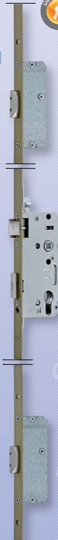
**Serrure 3 points à pêne rectangulaire ou 5 points à pêne cylindriques équipée d'un système de délation qui la bloque en cas d'arrachage ou détérioration du cylindre.**
